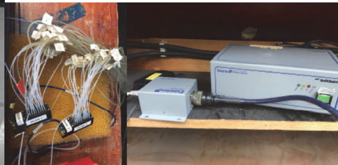
Abbildung 3.7 rechts: elektronische Druckscanner ESP-32/HD verkabelt links: DTC Initium System mit PSI's Model 91FC
