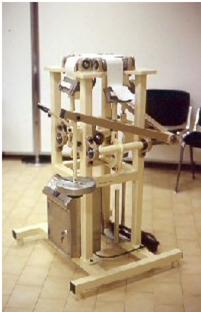
Dr. Trompette biaxial tension rig, Lyon
